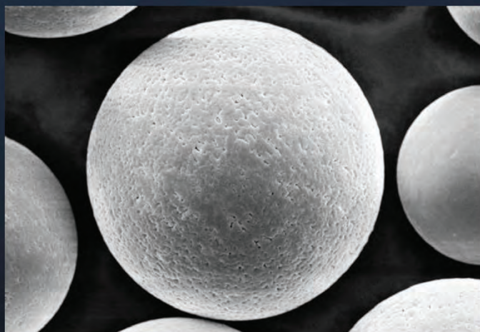
Сферическая частица порошка стали IN718, полученная в ATO Lab Plus
